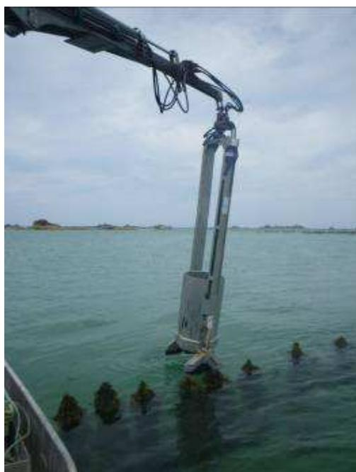
Figure 2. Pêcheuse - prélève les corde de moules sur les pieux.
