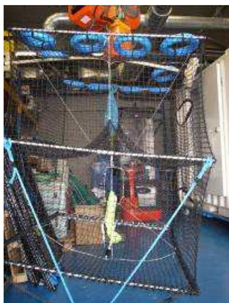
Figure 6. Modification de la goulotte rectangulaire et verticale, adapté à la morphologie de la dorade.
