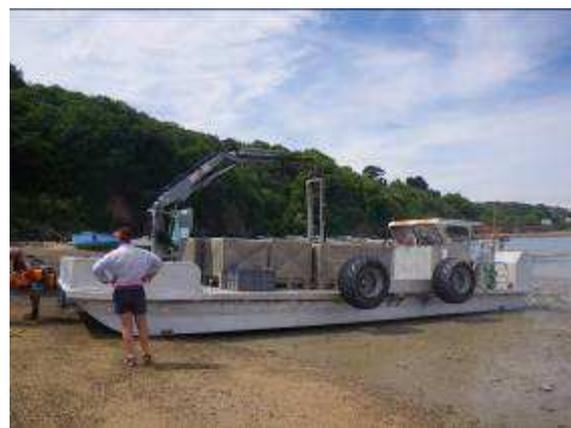
Figure 12. Chaland conchylicoles utilisés pour le mouillage et le virage des nasses le premier et le dernier jour des opérations.
